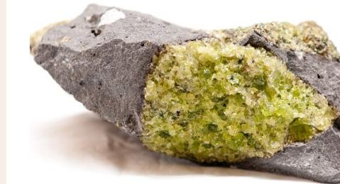
Geoengineering: Bei der Verwitterung der Gesteinsart Olivin wird der Atmosphäre CO<sub>2</sub> entzogen
